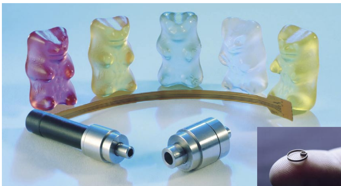
◀ Das Herzstück des Roboters: Der Micro-Harmonic-Drive Antrieb (großes Bild) mit dem winzigen Mikrogetriebe (kleines Bild).
