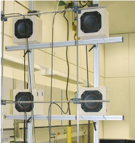
▲ Experimenteller Aufbau einer Lautsprecher-Fehlermikrofon-Anordnung zur aktiven Schallreduktion.
